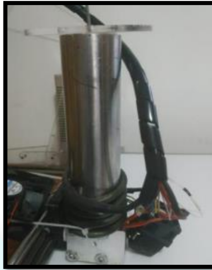
Imagen 4. Tolva con resistencia calefactora, Fuente: (Garcia Rios, 2019)
